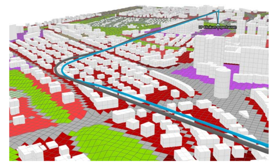
Für die Berechnung der Schall-Immissionspunkte vorbereitetes 3D-Geodaten Rastermodell für einen Ausschnitt des Testgebietes
