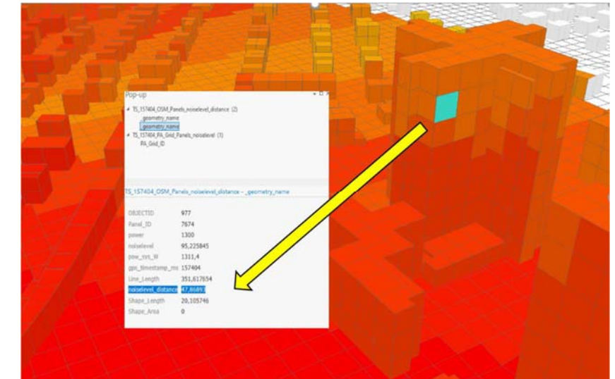
Über die 3D-GIS-Auswertung berechnete Lärm-Attributwerte für eine beispielhaft einzeln ausgewählte Gebäudekachel
