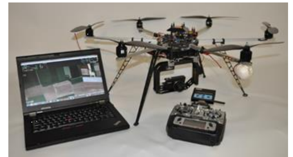
Abbildung 2: Unbemanntes Luftfahrtsystem bestehend aus Hexakopter mit Kamera, Funkfernsteuerung und Bodenstation
